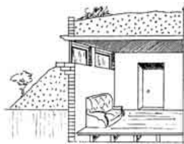
Зенитное окно; тип окна при большом заглублении.
